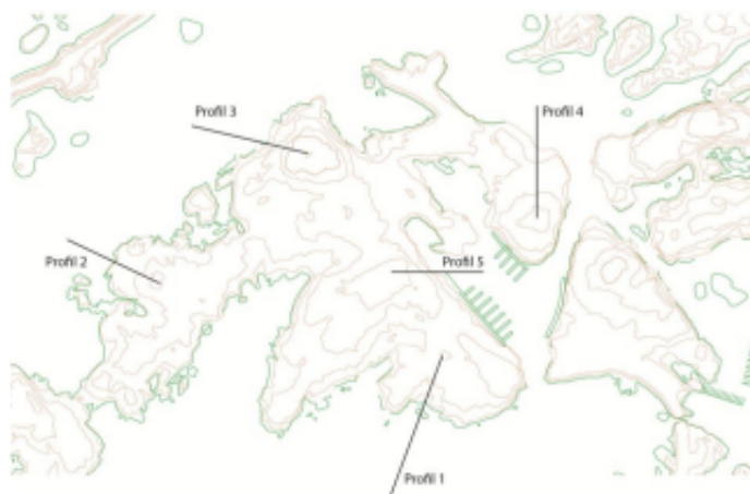
Figur 3 viser profiler for undersøkelse av bølgeopp skyl ling. Kystlinje markert i grønn farge. Høydekoter markert i rødt, ekvidistanse 1m. (Multiconsult 2014, dokumentkode 712185-RIMT-RAP-001).
