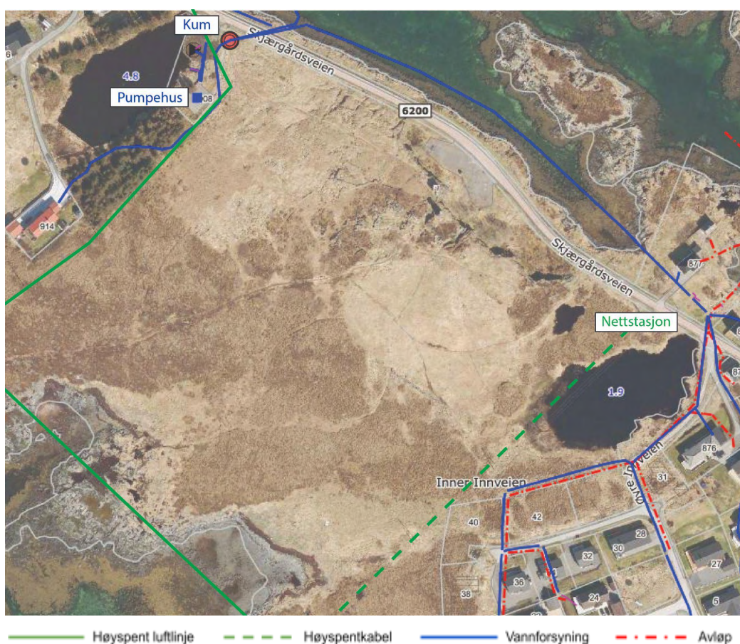
Teknisk infrastruktur i tilknytning til planområdet (ref NVE Atlas, Mellom AS og Smøla kommune).
