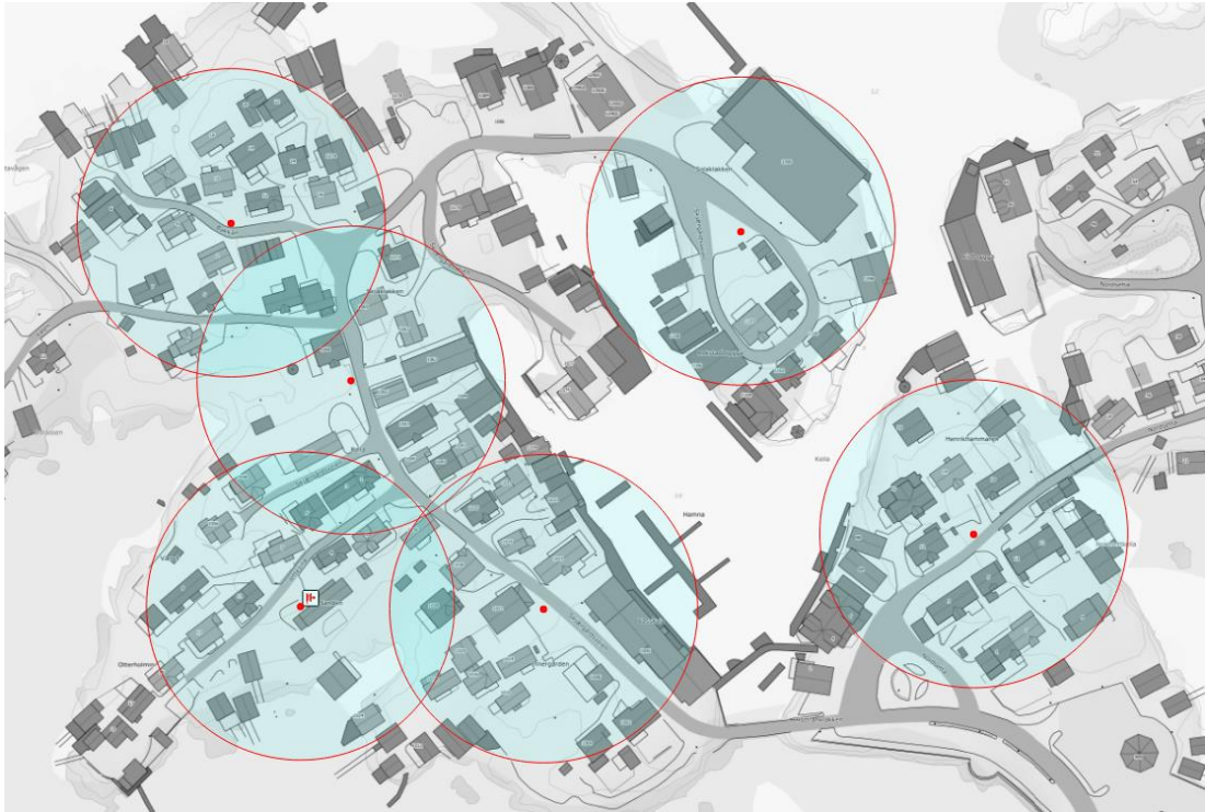
Figur 26: Anbefalt plassering må justeres/optimaliseres ved ifm. anskaffelse/detaljprosjektering. Plassering tar ikke hensyn til vannledningens plassering og hvor graving er mulig.
