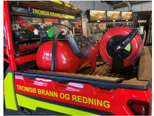
Figur 23: CAFS-system montert på UTV.
