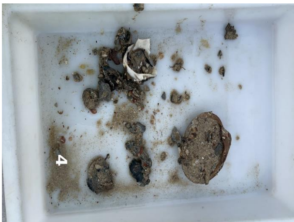
Figur 9: Bilder som viser sedimentet fra stasjon 4 før og etter siling. Sedimentet besto av sand og skjellsand på steinbunn. Foto: Aqua Kompetanse AS.
