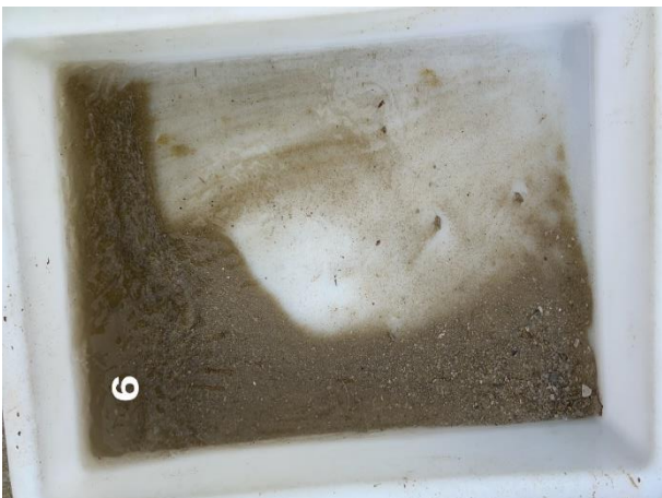
Figur 14: Bilder som viser sedimentet fra stasjon 9 før og etter siling. Sedimentet besto av sand og skjellsand. Foto: Aqua Kompetanse AS.
