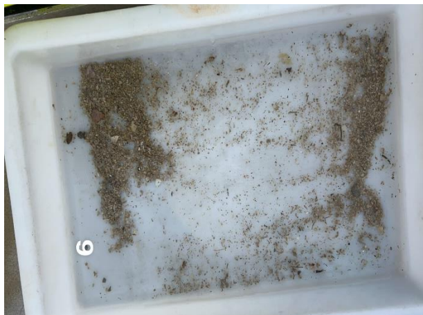
Figur 14: Bilder som viser sedimentet fra stasjon 9 før og etter siling. Sedimentet besto av sand og skjellsand. Foto: Aqua Kompetanse AS.
