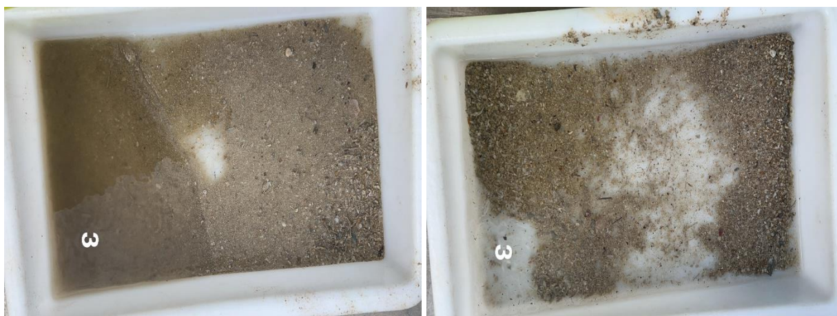
Figur 8: Bilder som viser sedimentet fra stasjon 3 før og etter siling. Sedimentet besto av sand og skjellsand. Foto: Aqua Kompetanse AS.
