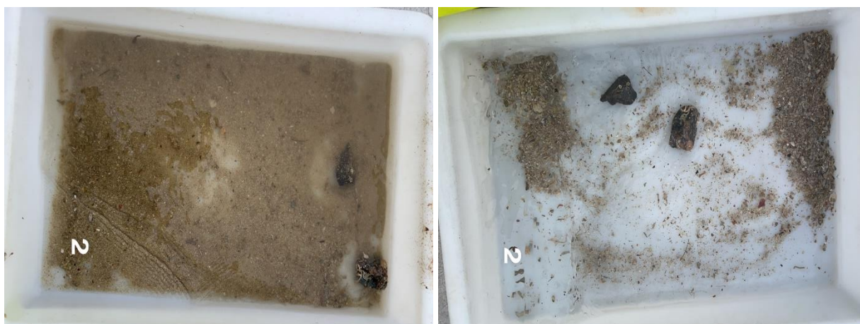
Figur 7: Bilder som viser sedimentet fra stasjon 2 før og etter siling. Sedimentet besto av sand og skjellsand. Foto: Aqua Kompetanse AS.
